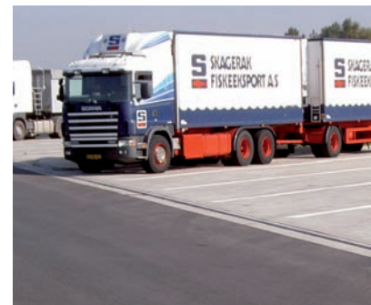
Lkw parken mit dem Führerhaus autobahn- abgewandt sicher auf VS 5-Pflaster. (Rastanlage auf der Westseite).
